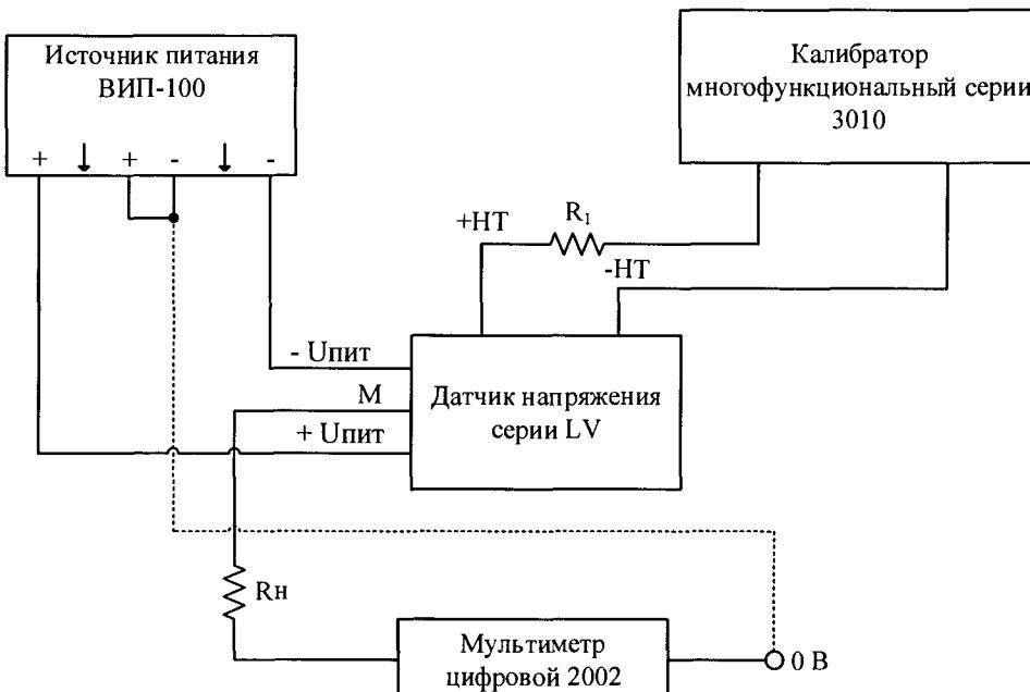
$R_n$  – значение сопротивления нагрузки датчика напряжения (см. паспорт);
