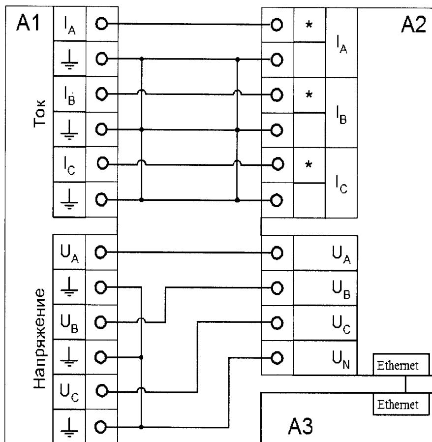
A1 – источник испытательного сигнала (калибратор переменного тока)
