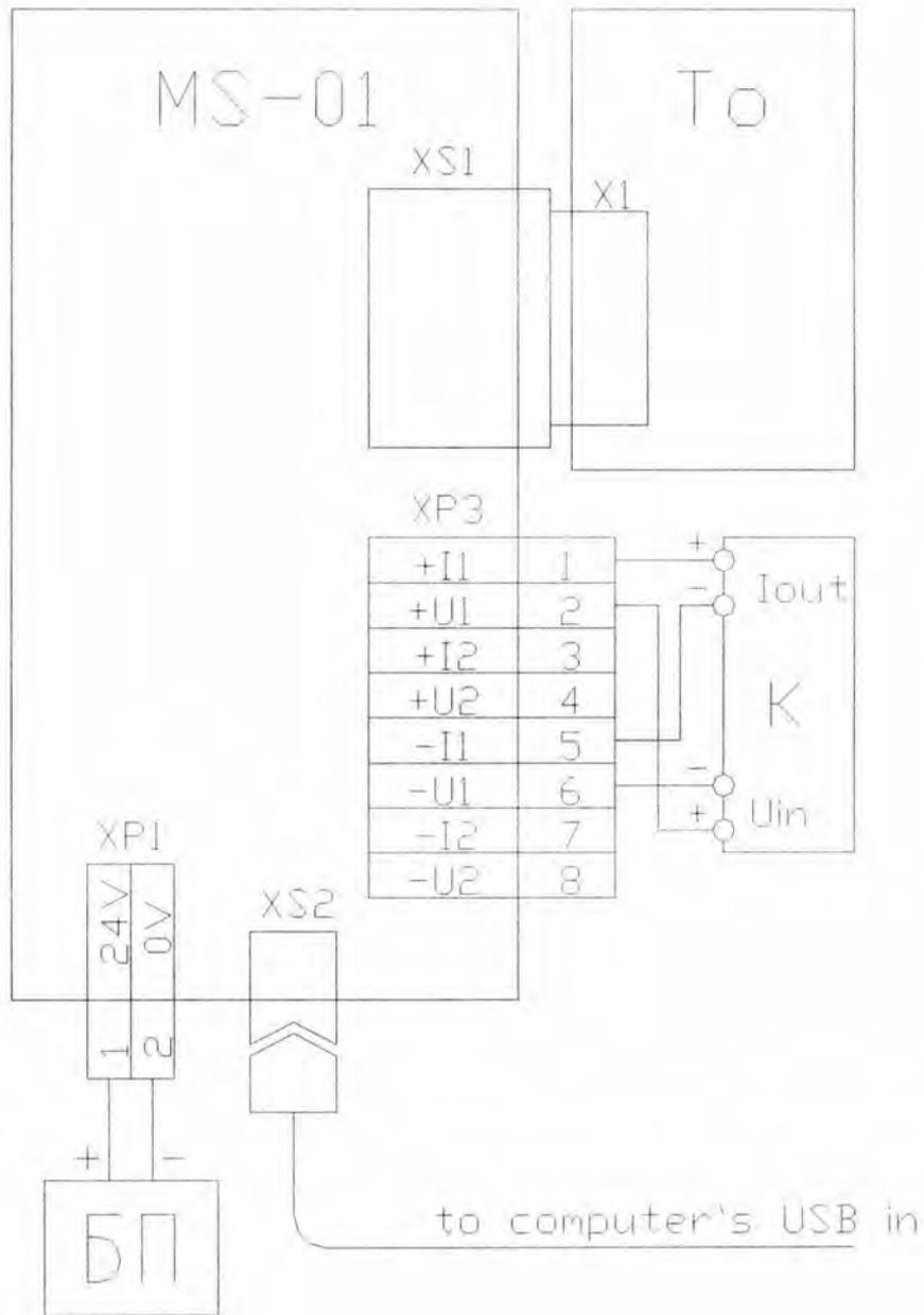
Схема подключения модуля ввода-вывода для проверки электрической прочности и сопротивления изоляции
