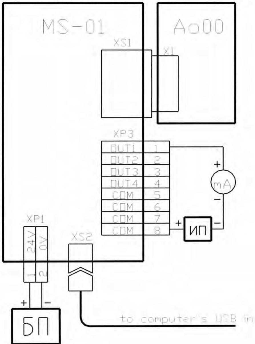
Схема подключения модуля АО 01
