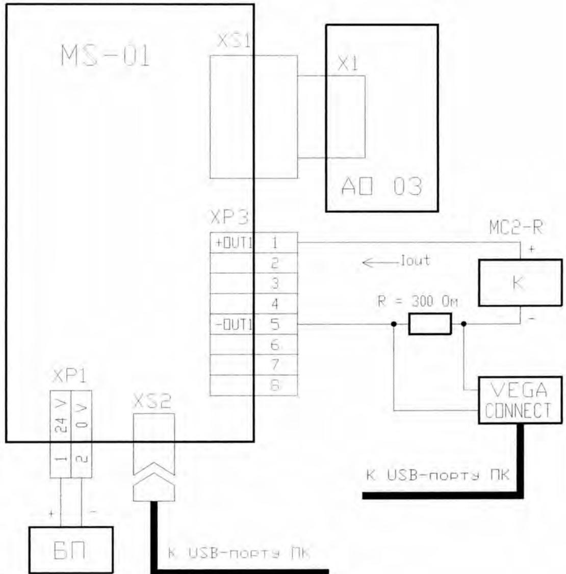
Схема подключения модуля АО 04
