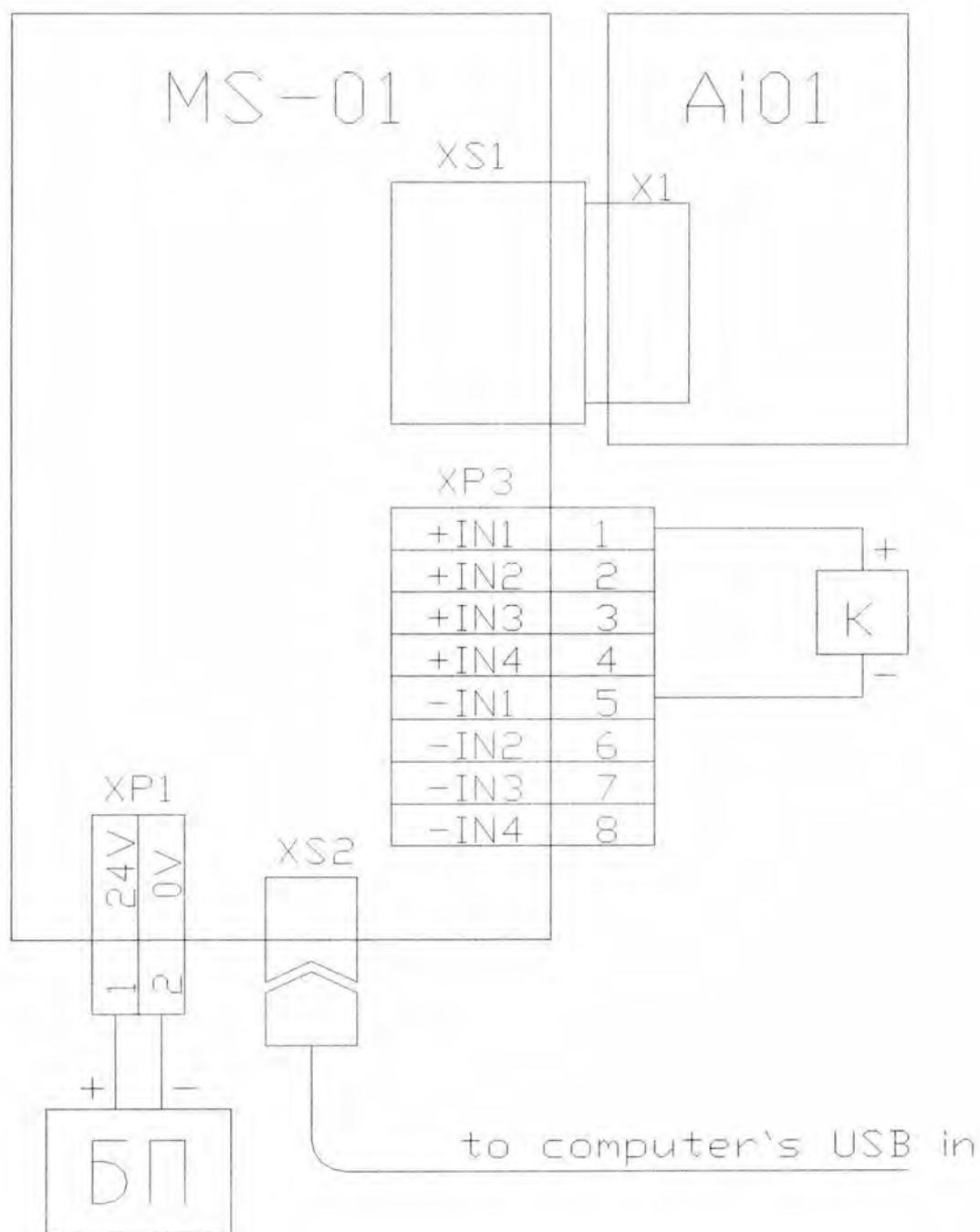
Схема подключения модуля АО 00
