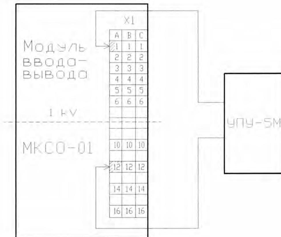
Схема подключения контроллера для проверки электрической прочности и сопротивления изоляции
