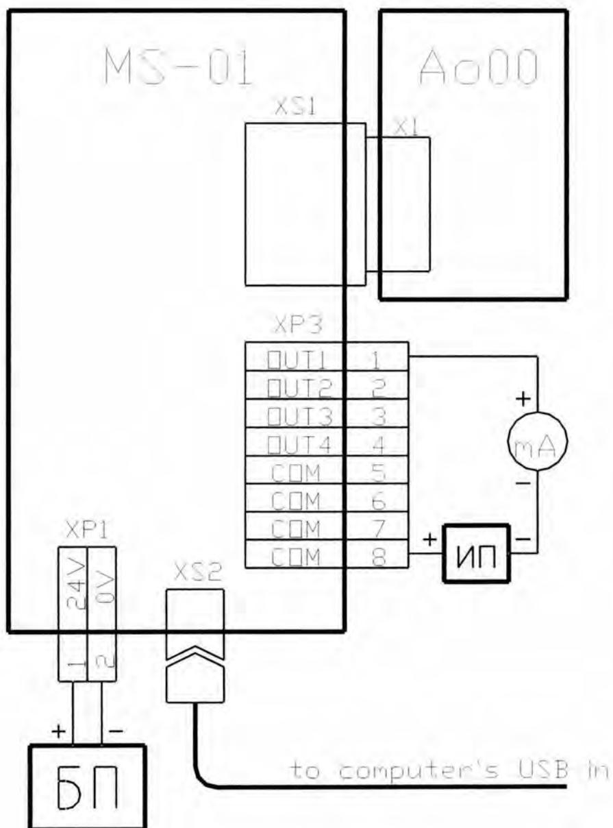
Схема подключения модуля ТО
