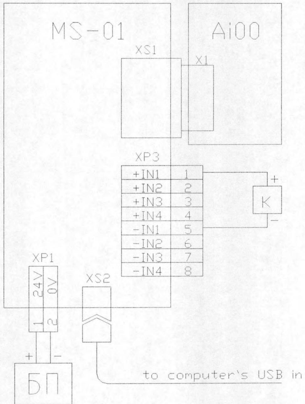
Схема подключения модуля AI 01
