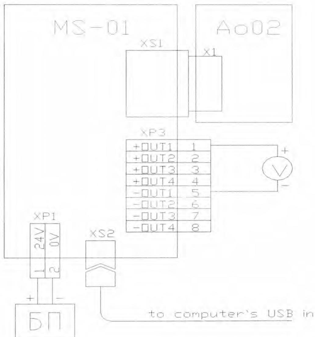
Схема подключения модуля АО 03
