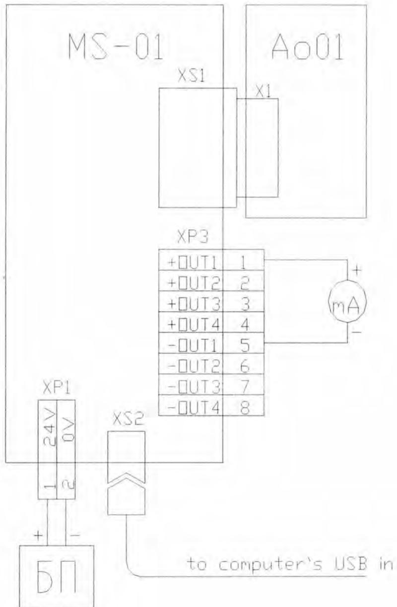
Схема подключения модуля АО 02
