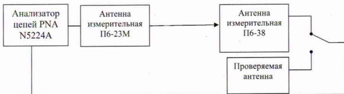
Рисунок 1 - Структурная схема соединения приборов
