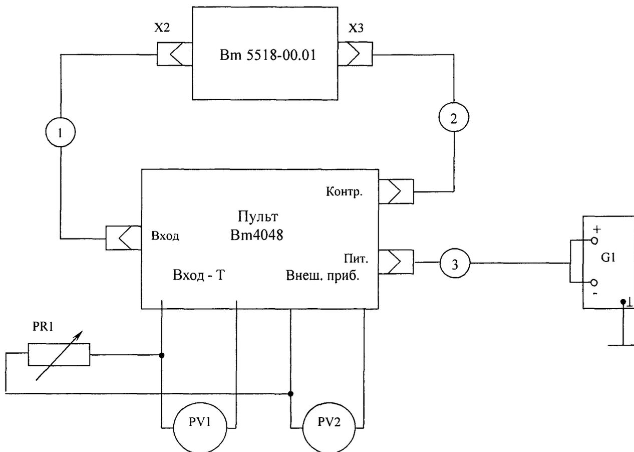
G1 – источник напряжения постоянного тока Б5-45;
