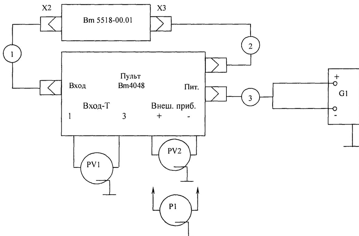
G1 – источник напряжения постоянного тока Б5-45;
