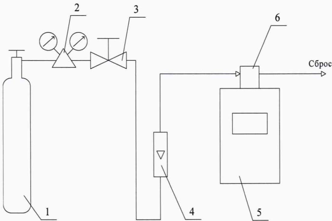
1 – баллон с ГС; 2 – редуктор; 3 – вентиль точной регулировки;
