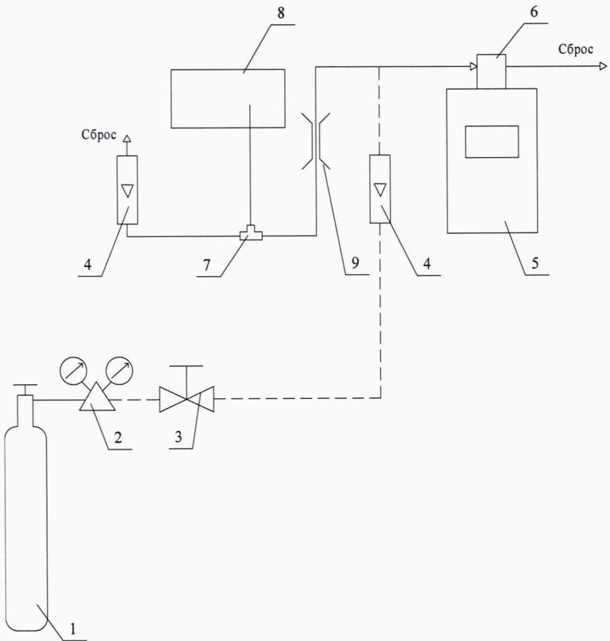
1 – баллон с ГС № 1 (ПНГ - воздух); 2 – редуктор; 3 – вентиль точной регулировки трассовый;
