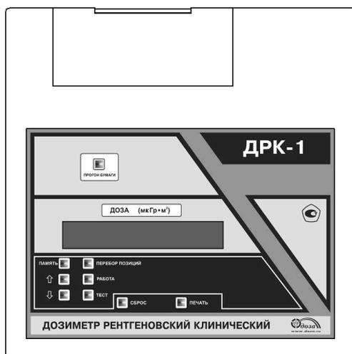
Рисунок 1.33 - Расположение управляющих клавиш
