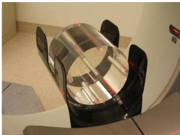
Рисунок 2.1 - Установка КТ-камеры
