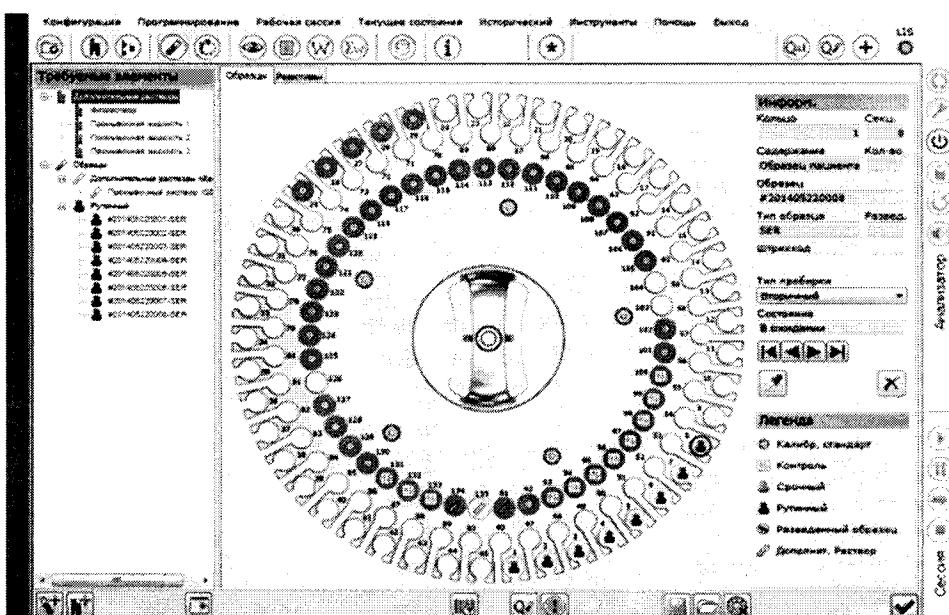
11 Нажать значок «» и затем «». Система сначала (~10 мин.) проводит промывку реакционного ротора, затем начинает измерения. После окончания измерения, зайти в меню текущие результаты и значения концентрации ионов списать с экрана, выбирая образец с № 1 по № 40, также можно распечатать результат, нажав на кнопку «печать» в левом нижнем углу.
