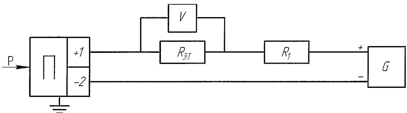
V – цифровой вольтметр или компаратор напряжения постоянного тока, указанные, например, в таблице 2;
