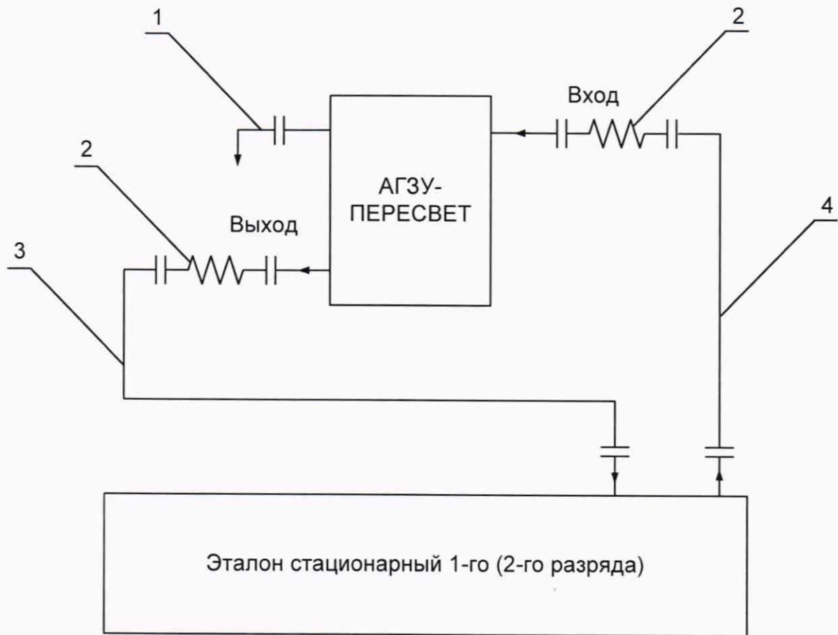
Рисунок А1. Гидравлическая схема подключения установки при поверке в условиях лаборатории
