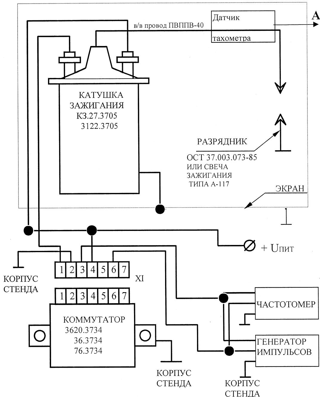
Схема для определения погрешности измерения частоты вращения коленчатого вала (позиция "A" схемы указывает на вход газоанализатора)
