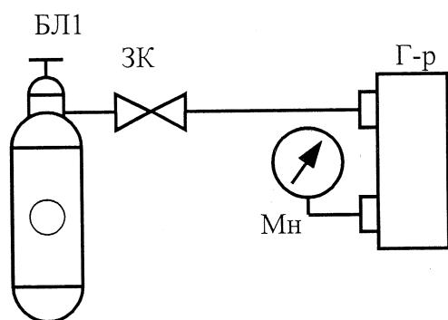
БЛ1-баллон с азотом ; ЗК – кран запорный, Мн –манометр ,
