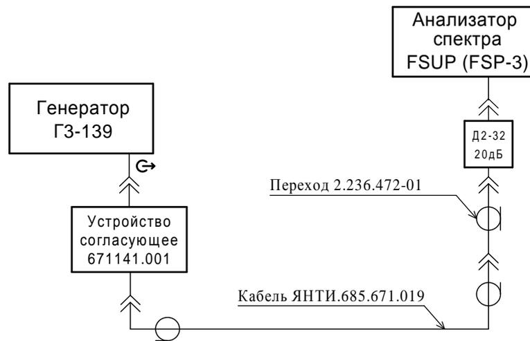
Рис. 7.10 Структурная схема измерения коэффициента гармоник на частотах от 10 кГц до 1000 кГц на нагрузке 600 Ом
