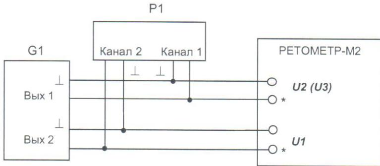
**G1** – источник, воспроизводящий углы сдвига фаз между напряжениями: РЕТОМ-51
