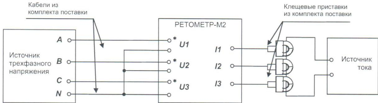
*Примечание – В качестве источников напряжения и тока рекомендуется использовать устройство РЕТОМ-51. В случае отдельных источников напряжения и тока, их необходимо синхронизировать по фазе.*
