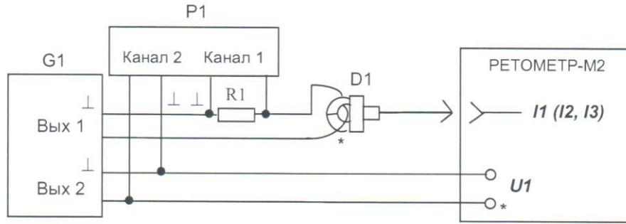
G1 – источник, воспроизводящий углы сдвига фаз между током и напряжением: PETOM-51 или УППУ-1М ( $U_{вх} = 0,6 \text{ В; } 100 \text{ В; } I_{вх} = I_1 = I_2 = I_3 = 0,25 \text{ А; } 5 \text{ А}$ );
