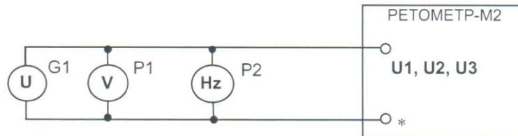
G1 – источник (генератор) напряжения постоянного и переменного тока: Н4-11 (до 600 В), УППУ-1М (до 750 В); PETOM-51 с PET-TH (от 600 до 750 В); PETOM-6000 (от 600 до 750 В);
