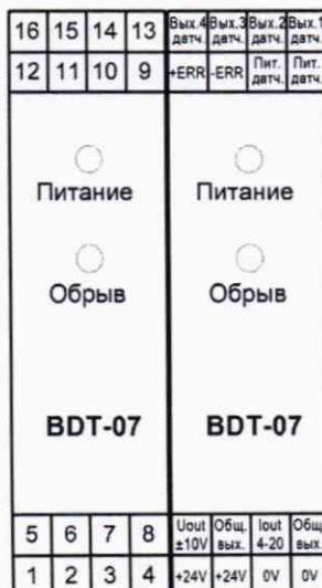
Рисунок 1 – Назначение контактов соединителей блока BDT
