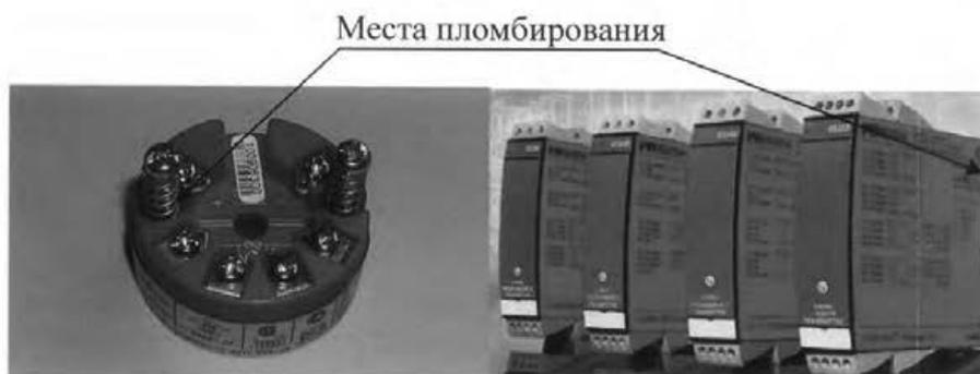
Рис.3 Внешний вид преобразователей измерительных PR серии 6.
