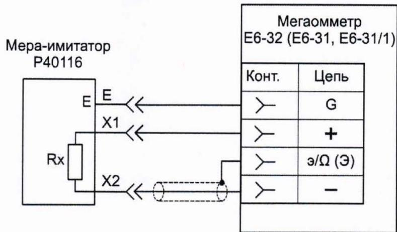
Рисунок 6.2 - Схема проверки погрешности при измерении сопротивления изоляции
