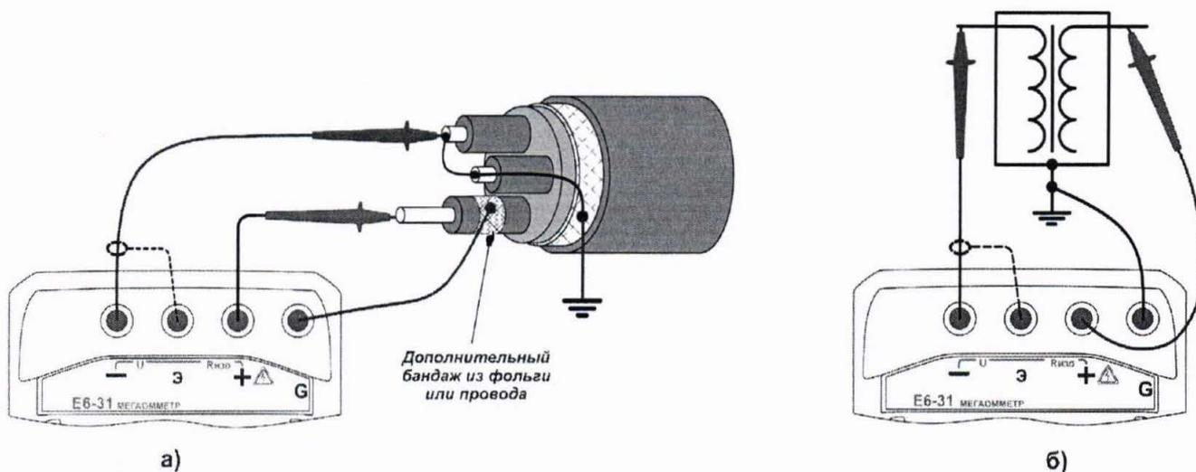
Рисунок 2.12 – Снижение влияния поверхностных токов утечки
