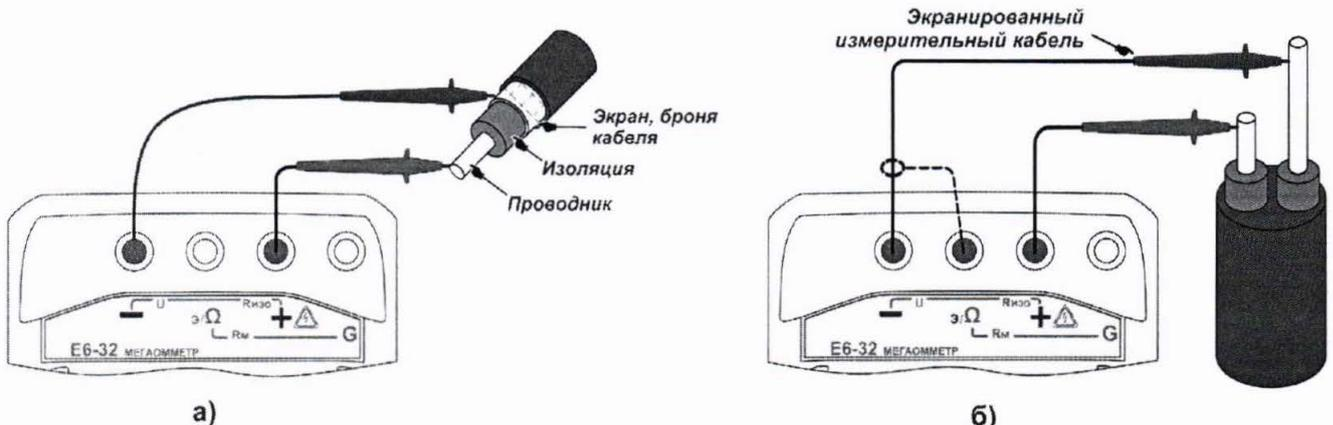
Рисунок 2.5 - Измерение сопротивления изоляции кабеля
