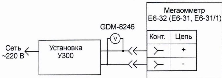
Рисунок 6.1 - Схема проверки погрешности при измерении напряжения
