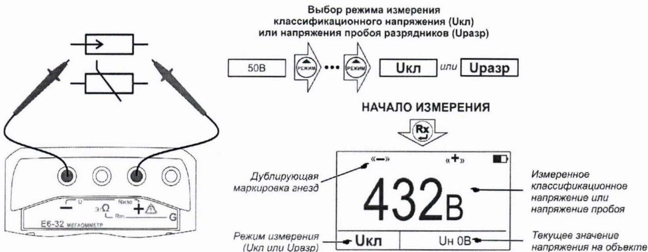
Рисунок 2.10 - Измерение классификационного напряжения или напряжения пробоя разрядников
