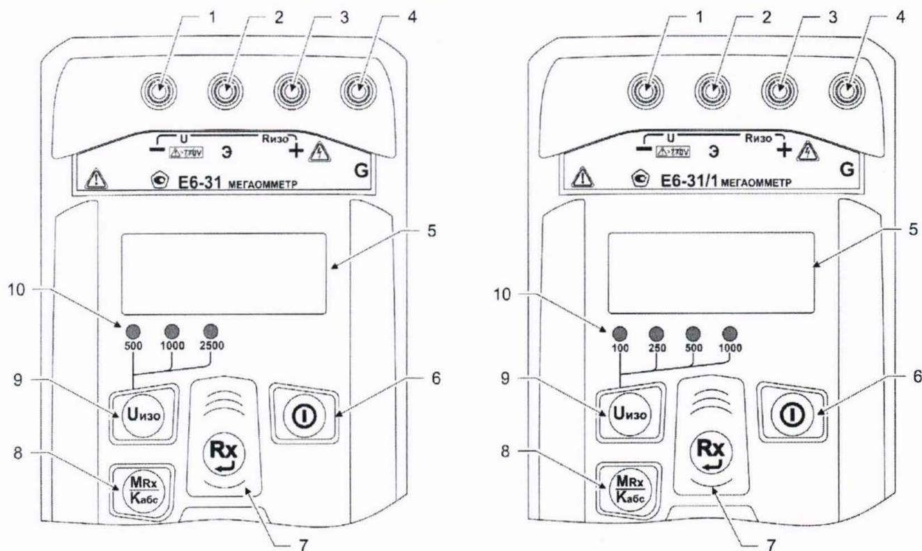
Рисунок 1.3 - Расположение разъёмов подключения и органов управления прибора E6-31 и E6-31/1
