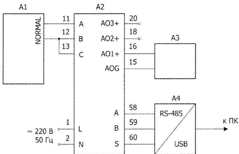
б) Подача напряжения переменного тока на канал измерения  $U_{BC}$ :
