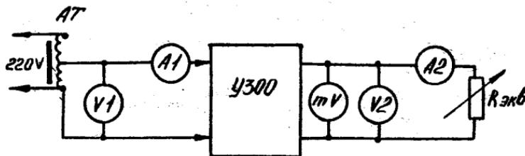
V1 - вольтметр для измерения напряжения сети, 250 В, кл. 2,5;
