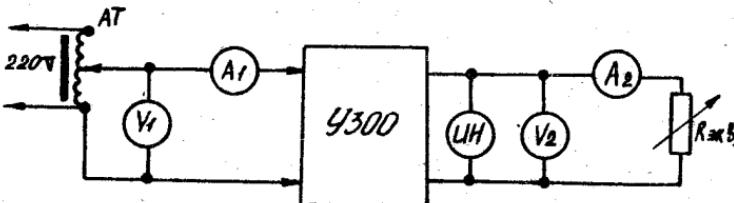
V1 - вольтметр для измерения напряжения сети, 250 В, кл. 2,5;
