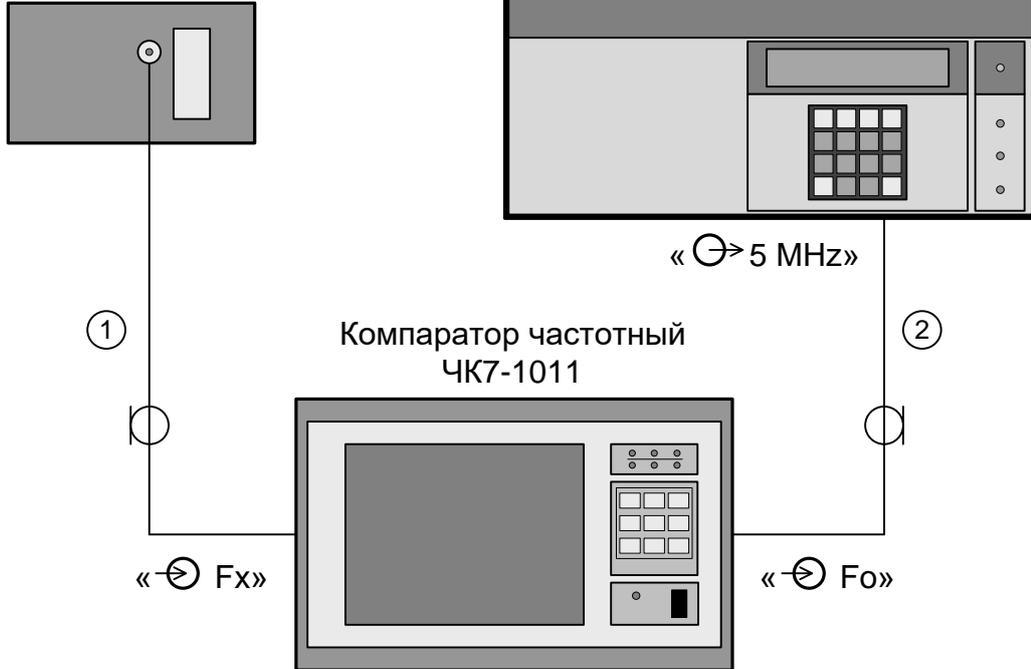
Рисунок 7.1 – Схема электрическая подключения приборов для определения относительной погрешности по частоте выходного сигнала, систематического относительного изменения частоты за 1 мес. и среднеквадратического относительного двухвыборочного отклонения частоты за 1 с, 10 с, 100 с и 1 сут.
