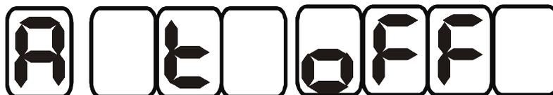
Рис. 16. Вид индикатора при включенном маскировании канала температуры.
