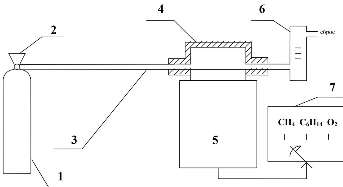
1 - баллон с ПГС; 2 - вентиль тонкой регулировки; 3 - соединительные трубки; 4 - адаптер; 5 - блок датчиков; 6 - ротаметр; 7 - блок индикации с переключателем каналов измерений (масштабы не соблюдены)
