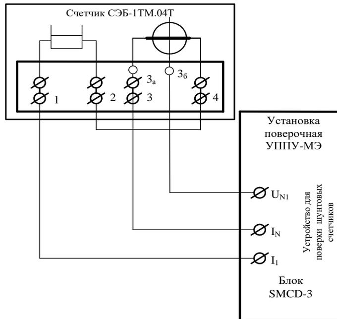
Примечание – По схеме, приведенной на рисунке А.2, подключать только один счётчик.
