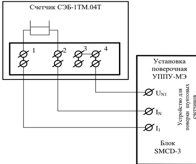
Рисунок А.1 - Схема подключения счётчиков с одним датчиком тока к установке УППУ-МЭ
