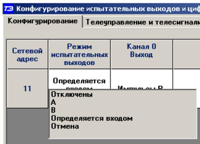
Рисунок 7 - Конфигурирование основного (А) и поверочного (В) режима телеметрии
