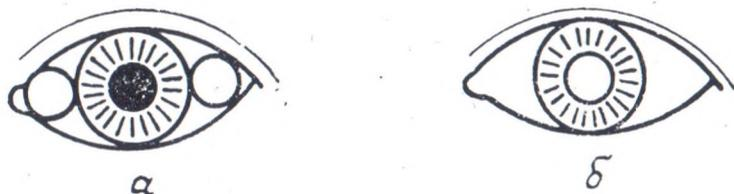
Рис. 2. Расположение световых пятен по отношению к глазу при предварительной установке головки в рабочее положение: *а* — в процессе установки; *б* — в установленном положении.
